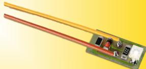
**Platine mit zwei LEDs für Hausbeleuchtung:**
