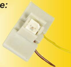
**Platine mit einer LED für Hausbeleuchtung:**
